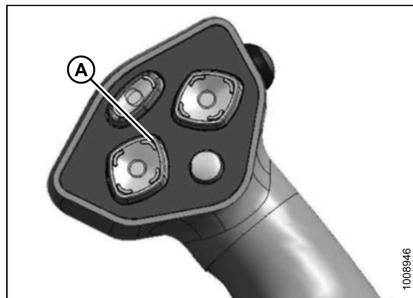
Рисунок 4.67: Рычаг наземной скорости (GSL)
