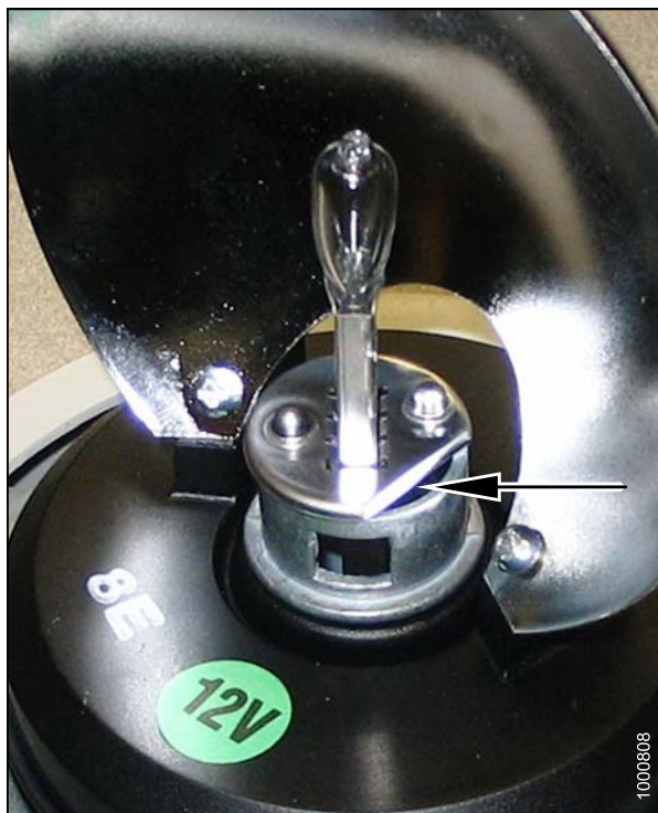
Рисунок 5.173: Установка лампы в проблесковый маячок
