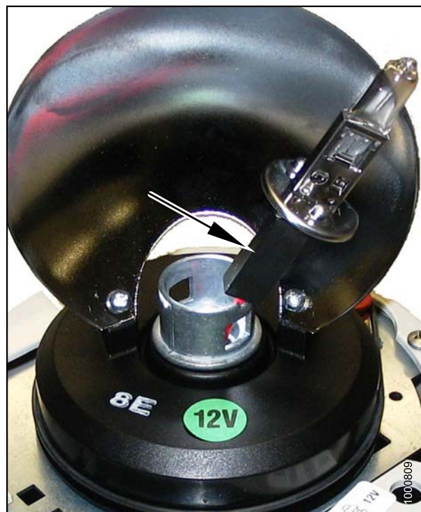
Рисунок 5.172: Установка лампы в проблесковый маячок
