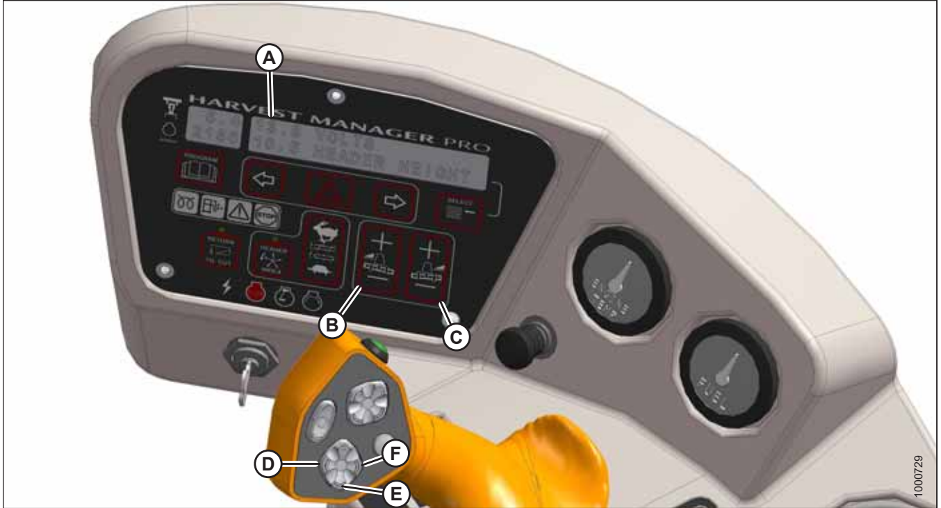
图 4.74: 驾驶室显示模块 (CDM) 浮动悬挂调整
