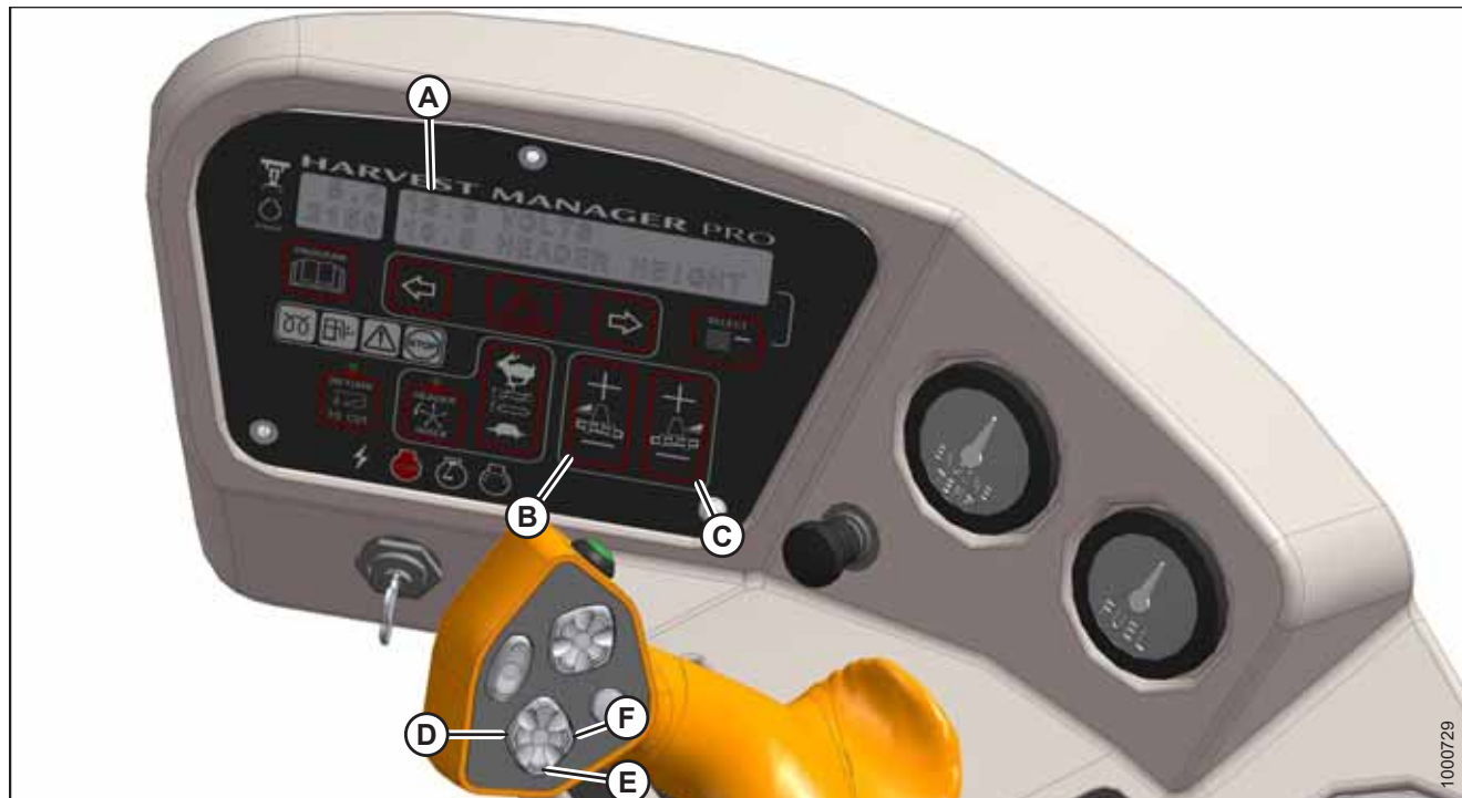
图 4.70: 驾驶室显示模块 (CDM) 浮动悬挂调整
