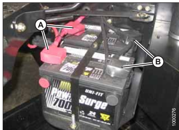
图 5.120: 蓄电池接线端子位置
