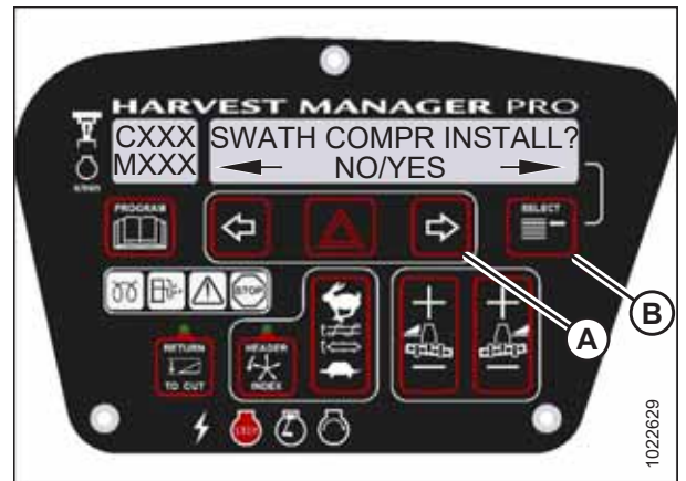
图 3.99: 放铺导板控制装置
