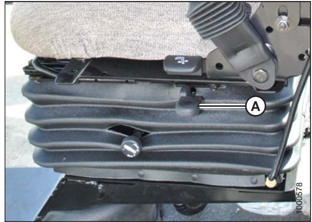
图 3.8: 前后移动定位锁
