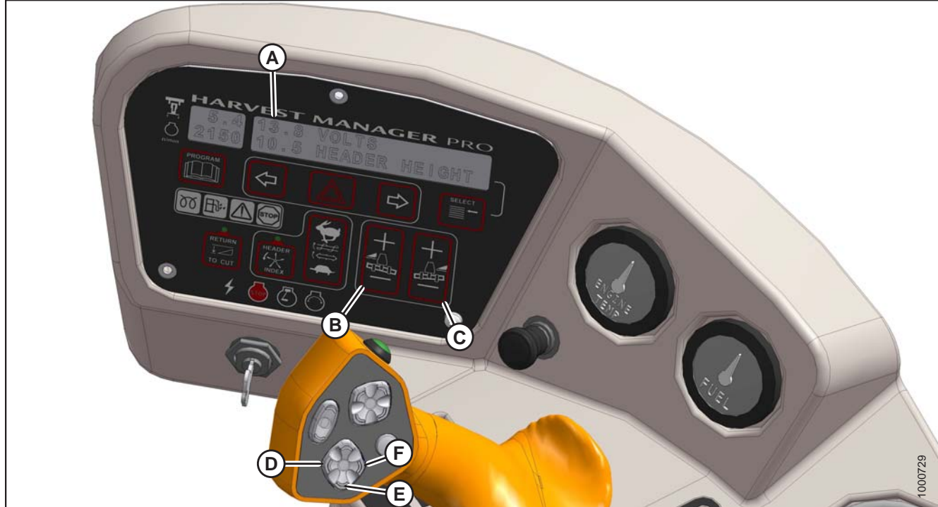
A - CDM 显示屏 B - 左侧浮动悬挂调整 C - 右侧浮动悬挂调整 D - 割台向下倾斜 E - 割台下降 F - 割台向上倾斜
