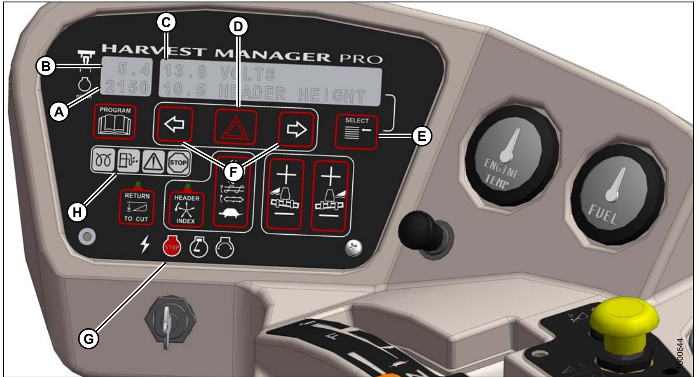
图 3.61: CDM 发动机和割晒机功能
