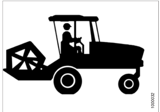
pav. 4.35: Važiavimas varikliu į priekį – sėdynė atsukta į variklį
