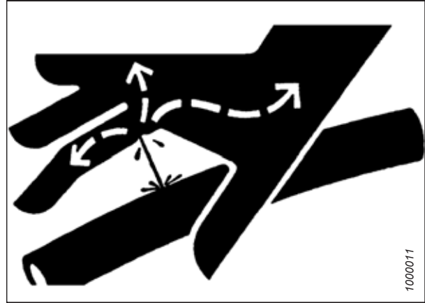
Abbildung 5.55: Gefährdung durch Hydraulikdruck
