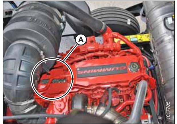
Abbildung 3: Anbringungsort der Motorseriennummer
