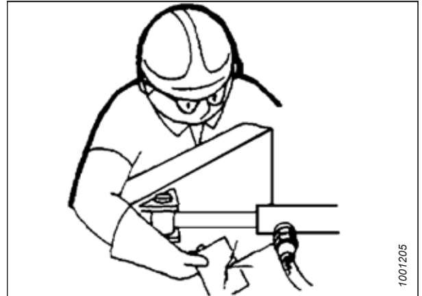
Abbildung 1.11: Suche nach undichten Hydraulikstellen
