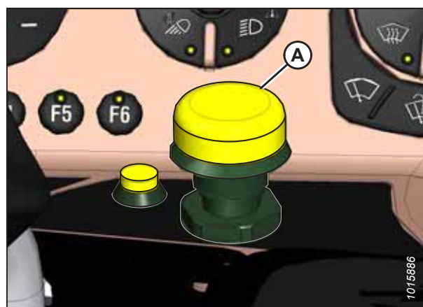
Abbildung 4.241: Schalter SCHNEIDWERKS BETRIEB
