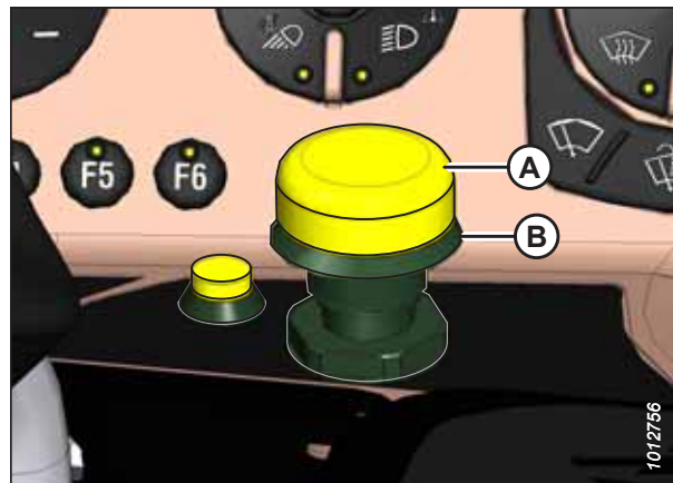
Abbildung 4.239: Schalter SCHNEIDWERKS BETRIEB
