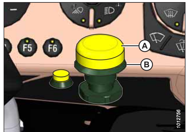
Abbildung 4.236: Schalter SCHNEIDWERKS BETRIEB
