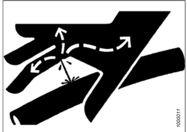
Abbildung 5.26: Gefährdung durch Hydraulikdruck
