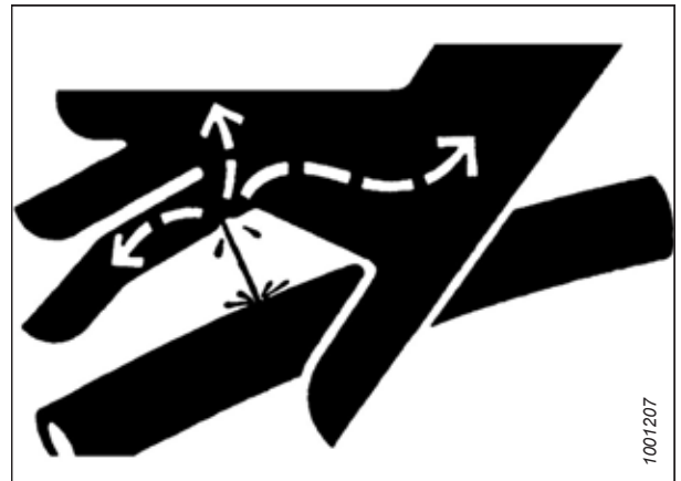
Abbildung 1.12: Gefährdung durch Hydraulikdruck
