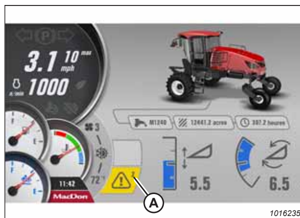
Figure 3.96: Icône des témoins - Défauts multiples détectés
