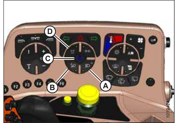
Figure 3.21: Commutateurs de lumière A - Feux de route B - Lumières de champ C - Faisceaux de route ou feux de croisement D - Signalisation
