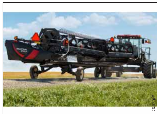
Figure 4.76: Remorquage d'une plateforme
