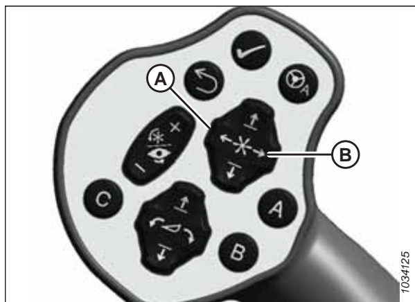
Figur 4.61: Betjeningsknapper til transport
