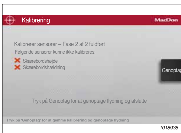
Figur 4.154: Eksempel på skærmmeddelelse om mislykket kalibrering
