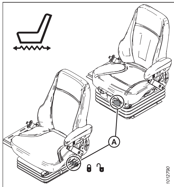
Figur 3.8: Betjeningsanordninger til førersædets isolering frem/tilbage
