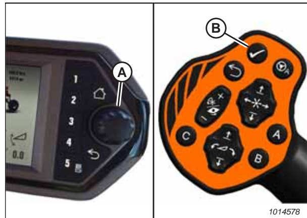
Figur 3.83: Rulleknop på HPT og knappen Vælg på GSL
