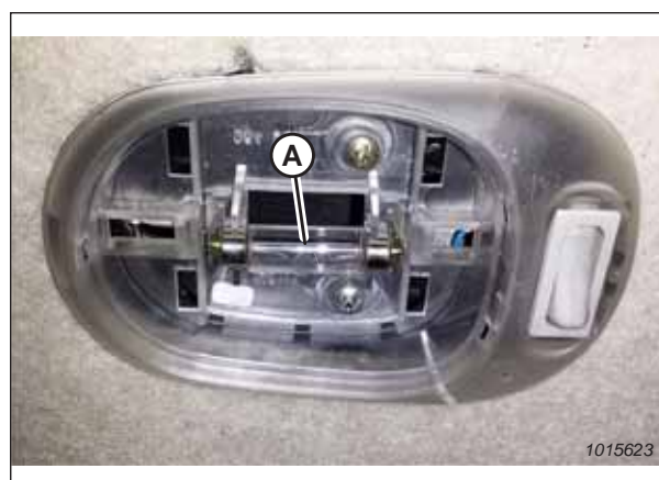
Figur 5.200: Kuppellys i førerhus med dæksel fjernet
