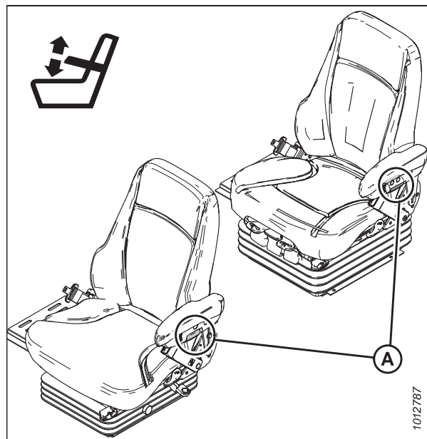
Figur 3.5: Betjeningsknapper til at indstille armlæsvinklen for førersædet
