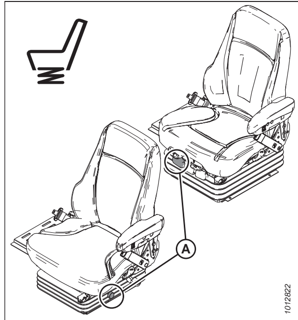
Figur 3.11: Betjeningsanordninger til førersædets lodrette støddaffjedring
