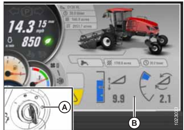
Figur 4.16: Skærm på HPT for frakoblet skærebord
