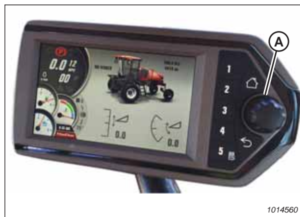
Figur 4.28: Rulleknop på HPT/knappen Vælg
