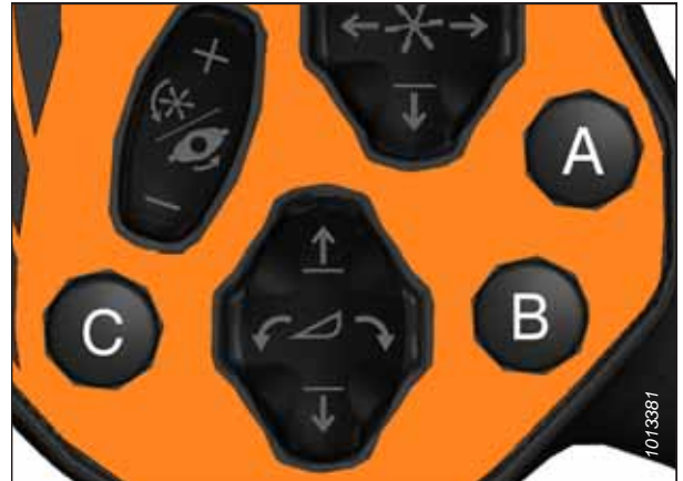
Figur 3.63: Knapper til One-Touch-Return på GSL
