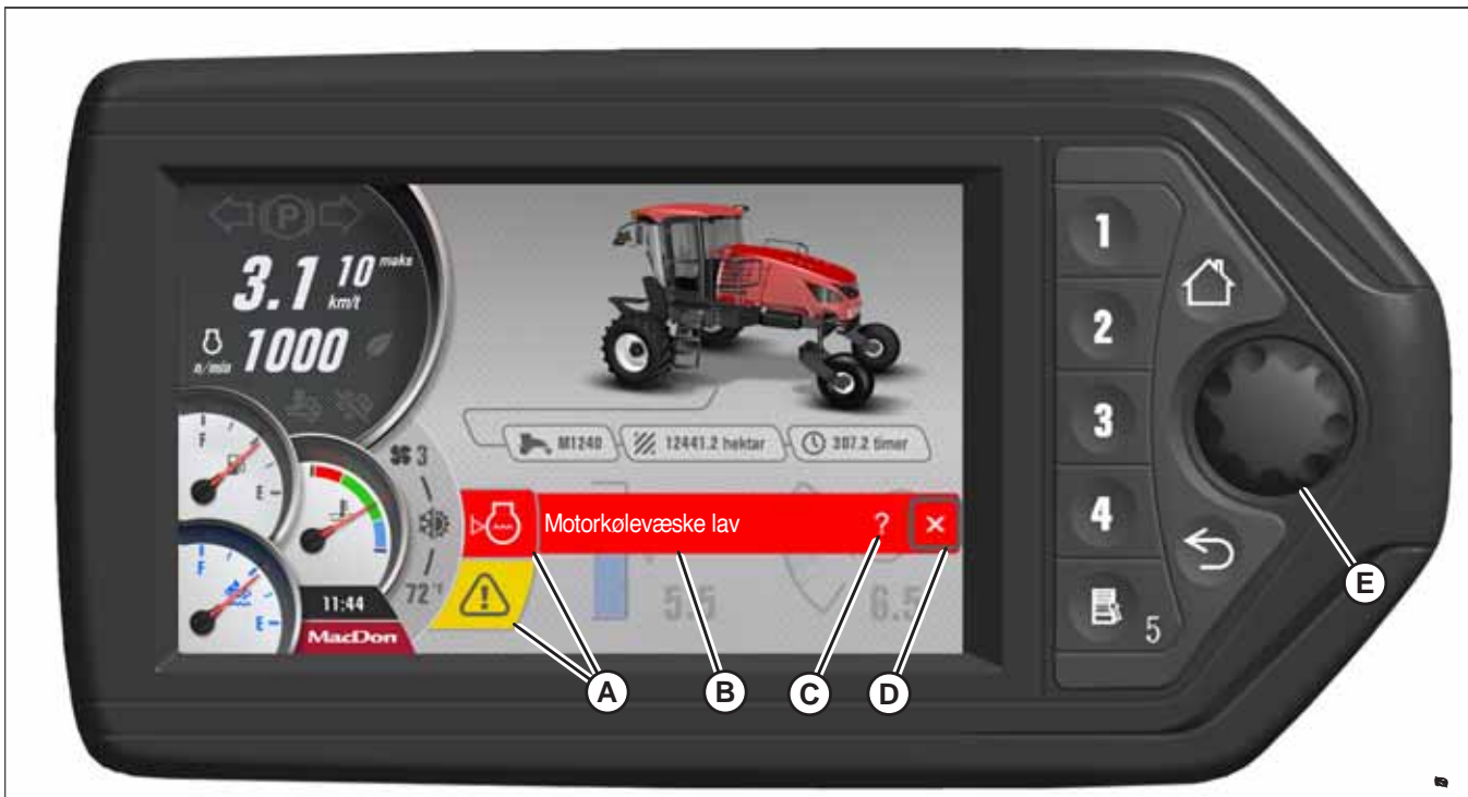
Figur 3.96: Kørselsskærmen på HPT, der viser fejl
