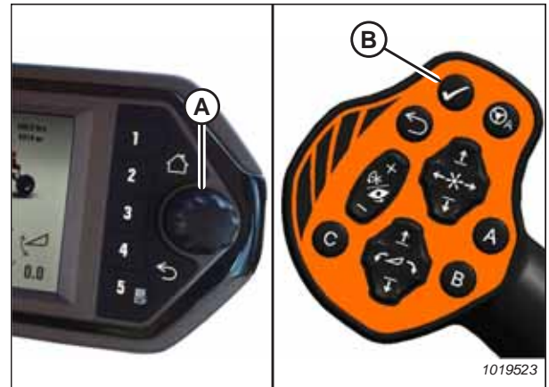
Figur 4.206: Rulleknop på HPT og knappen Vælg på GSL
