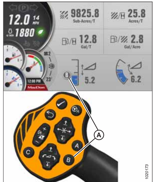
Figur 3.64: Knapper til One-Touch-Return på GSL
