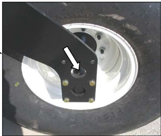
FORKED CASTER SPINDLE BEARINGS
