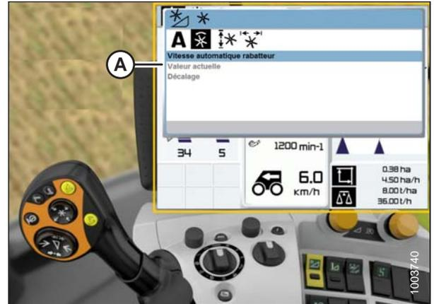
Figure 7.180: Écran, console et levier de commande de la moissonneuse-batteuse CLAAS
