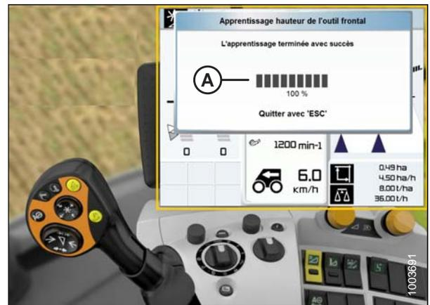
Figure 7.173: Écran, console et levier de commande de la moissonneuse-batteuse CLAAS
