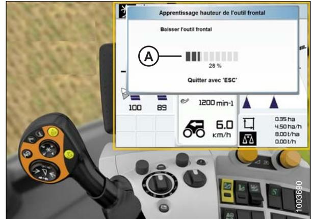
Figure 7.172: Écran, console et levier de commande de la moissonneuse-batteuse CLAAS
