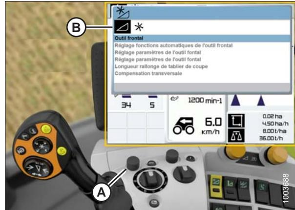
Figure 7.169: Écran, console et levier de commande de la moissonneuse-batteuse CLAAS
