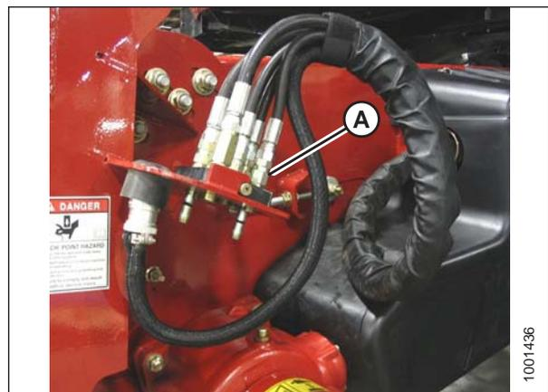
Figure 5.40: Connecteurs de la moissonneuse-batteuse
