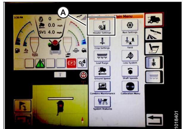
Figure 7.206: Paramètres de la plateforme dans le menu principal de la moissonneuse-batteuse
