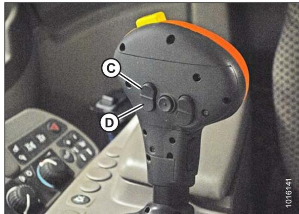
Figure 7.293: Poignée de commande John Deere
