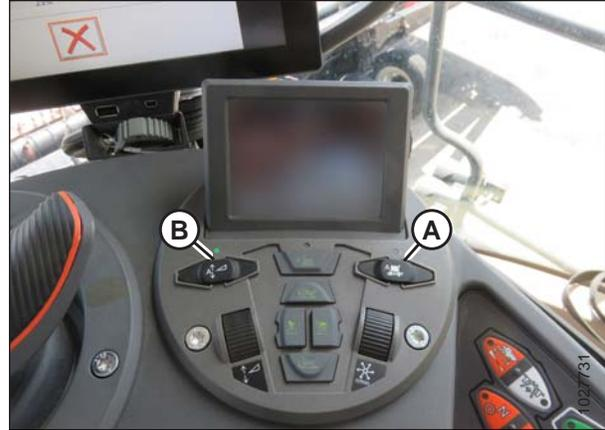
Figure 7.59: Groupe de commande de la plateforme
