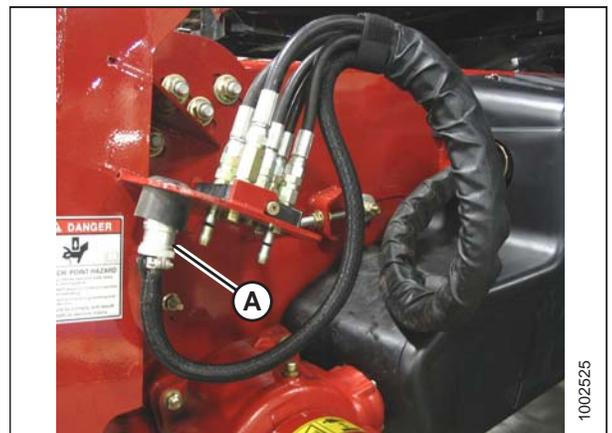
Figure 5.43: Connecteurs de la moissonneuse-batteuse
