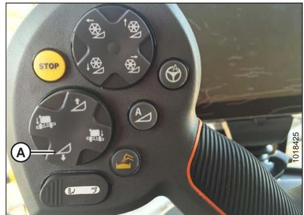
Figure 7.226: Commutateur d'abaissement de la plateforme
