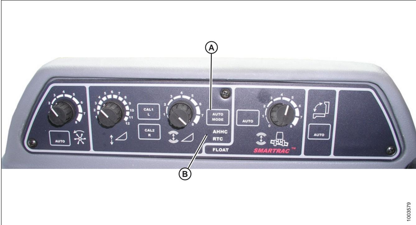
1. Appuyez sur le bouton MODE AUTO (A) jusqu'à ce que le voyant AHHC (B) s'allume. Si le voyant RTC clignote, appuyez à nouveau sur le bouton MODE AUTO (A) jusqu'à ce qu'il passe à AHHC.
