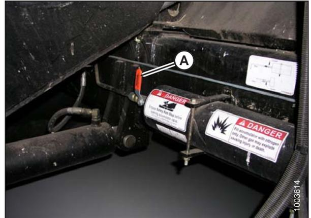
**Figure 7.197: Commutateur ON/OFF (marche/arrêt) de l'accumulateur de la moissonneuse-batteuse**
