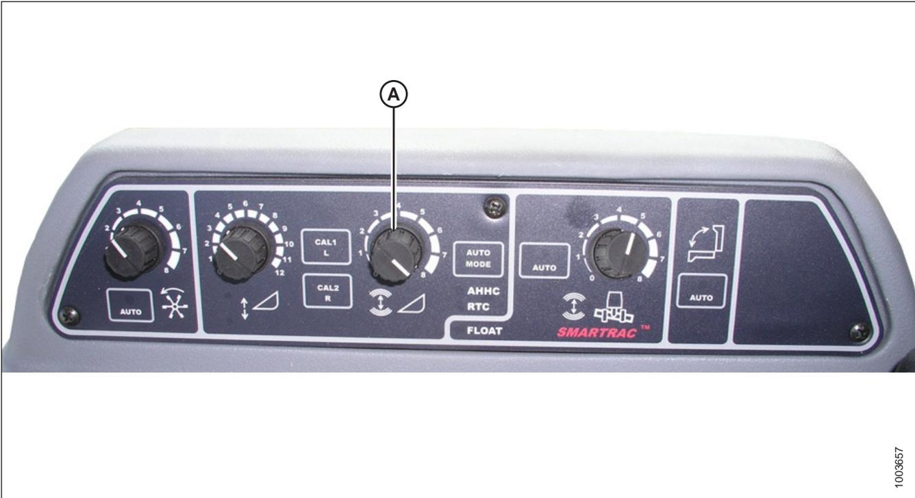
La molette de RÉGLAGE DE LA SENSIBILITÉ (A) contrôle la distance sur laquelle la barre de coupe doit monter ou descendre avant que le contrôle de hauteur automatique de la plateforme (AHHC) réagisse en levant ou en abaissant le convoyeur.
