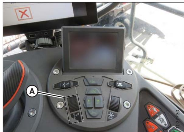
Figure 7.61: Groupe de commande de la plateforme
