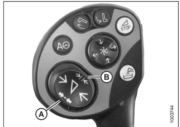
Figure 7.163: Boutons de la Poignée de commande CLAAS
