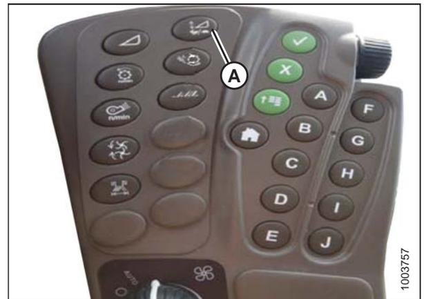
Figure 7.284: Centre de commande des moissonneuses-batteuses John Deere
