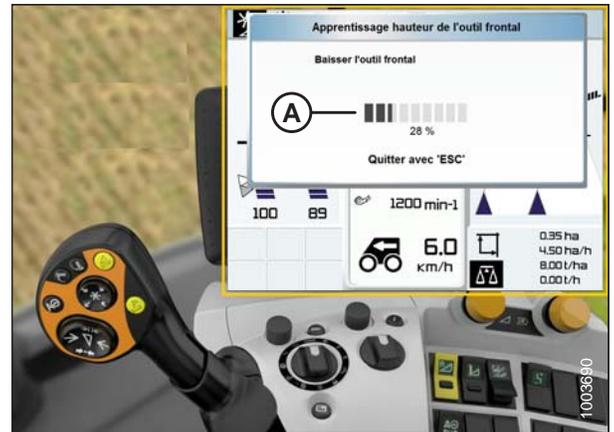
Figure 7.186: Écran, console et levier de commande de la moissonneuse-batteuse CLAAS
