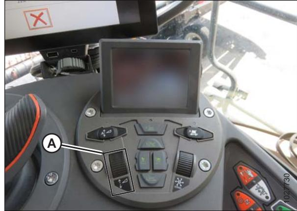
Figure 7.64: Groupe de commande de la plateforme
