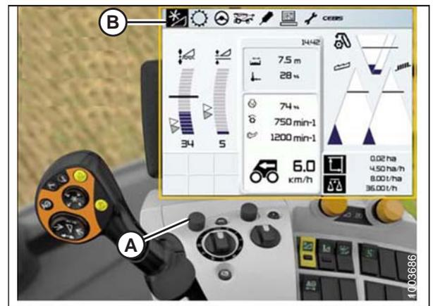
Figure 7.168: Écran, console et levier de commande de la moissonneuse-batteuse CLAAS
