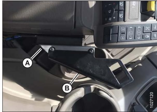
Figure 5.72: Vue de dessus de l'accoudoir montrant les supports installés dans un autre emplacement
