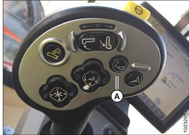
Figure 7.88: Poignée de commande de la moissonneuse-batteuse Case
