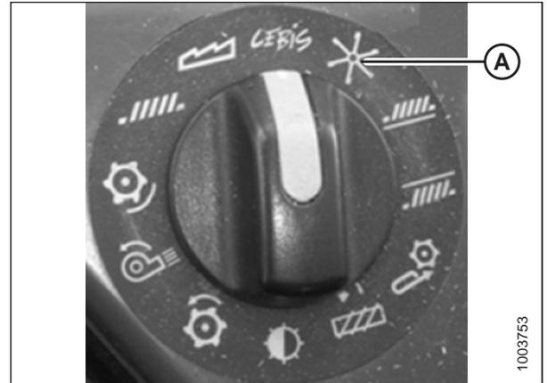
Figure 7.162: Sélecteur rotatif de la moissonneuse-batteuse CLAAS
