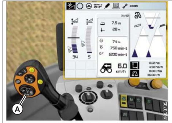
Figure 7.174: Écran, console et levier de commande de la moissonneuse-batteuse CLAAS
