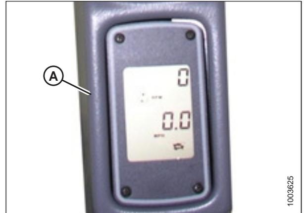
Figure 7.202: Tachymètre
