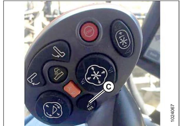
Figure 7.386: Poignée multifonction de la moissonneuse-batteuse New Holland
