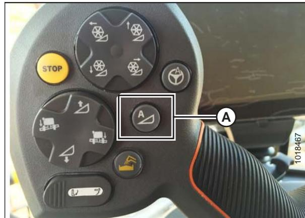
Figure 7.60: CHAP sur la poignée de commande
