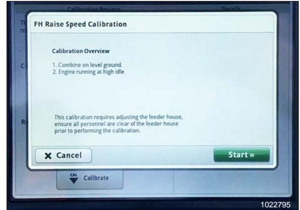
Figure 7.333: Écran John Deere S7 – Étalonnage du convoyeur
