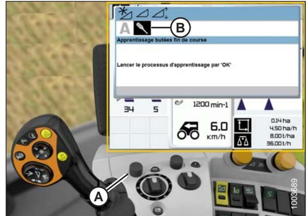
Figure 7.185: Écran, console et levier de commande de la moissonneuse-batteuse CLAAS
