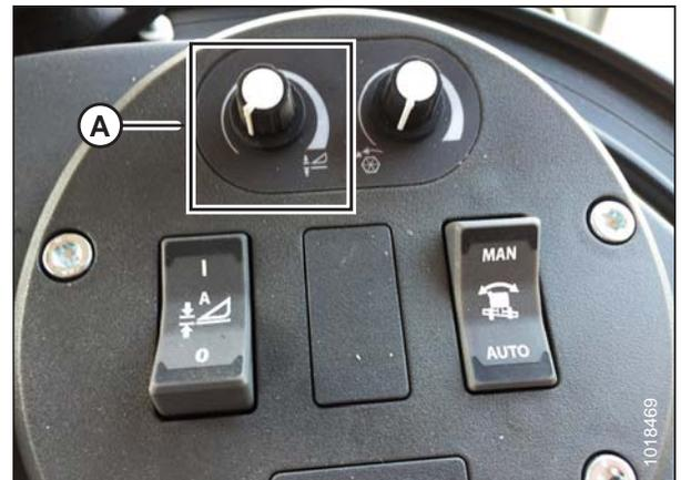
Figure 7.238: Groupe de commande de la plateforme
