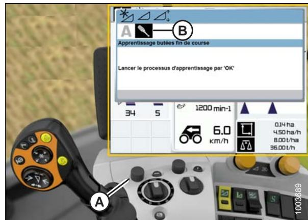
Figure 7.171: Écran, console et levier de commande de la moissonneuse-batteuse CLAAS
