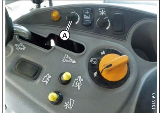
Figure 7.142: Bouton de réglage de la hauteur sur la console de commande de la moissonneuse-batteuse
