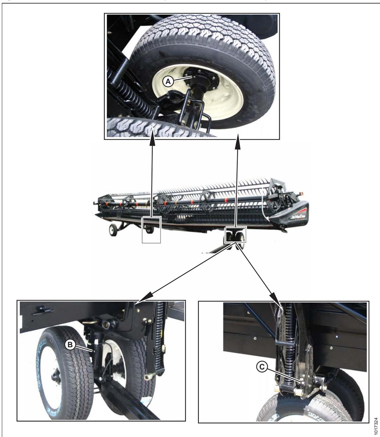
A – Roulements de roue (quatre endroits)
