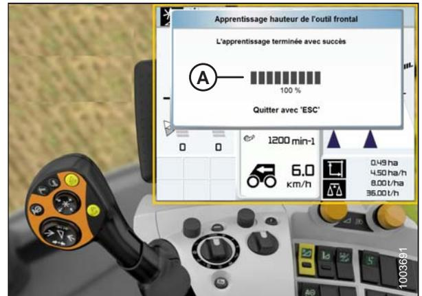
Figure 7.187: Écran, console et levier de commande de la moissonneuse-batteuse CLAAS
