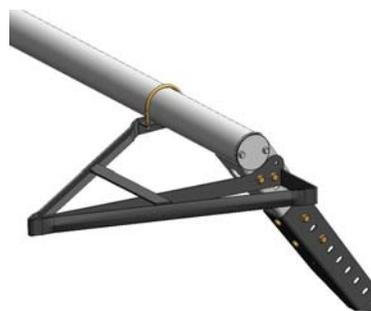
Делители устанавливаются на края жатки для лучшего разделения высоких культур и облегчения работы мотовила. В комплект входят левый и правый делители, удлинитель балки, монтажный комплект.
