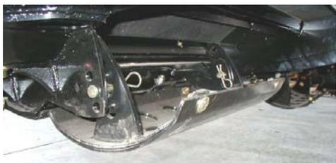
В дополнение к установленным 2м внешним башмакам, можно установить дополнительно 2 внутренних для лучшего контроля высоты среза и защиты компонентов режущего аппарата.
