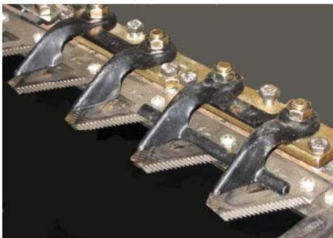
Режущий аппарат оборудован короткими защитными пальцами для эффективного срезывания грубых травяных культур.
