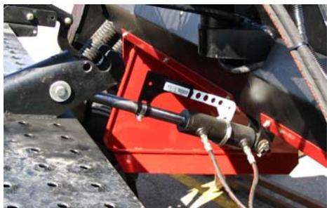
Этот комплект позволяет изменять угол жатки гидравлически с заменой механической растяжки на цилиндр. Для этого необходима отдельная гидравлическая цепь или в зависимости от трактора можно использовать существующую цилиндра дышла. Инструкции по установке прилагаются.
