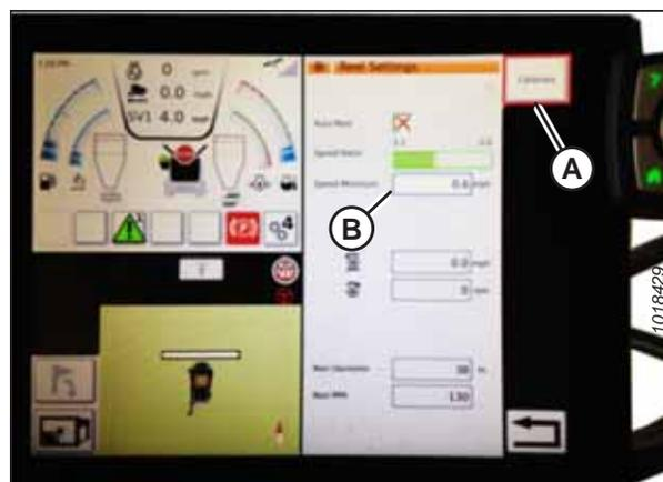
Figure 3.265: Étalonnage des réglages du rabatteur
