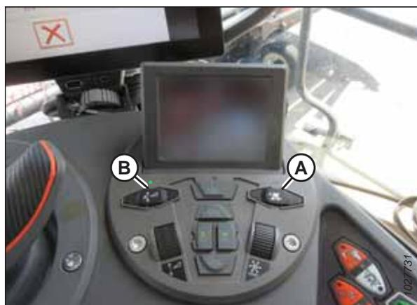
Figure 3.278: Groupe de commande de la plateforme
