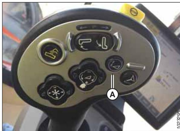
Figure 3.206: Poignée de commande de la moissonneuse-batteuse Case
