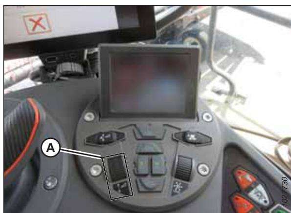
Figure 3.283: Groupe de commande de la plateforme
