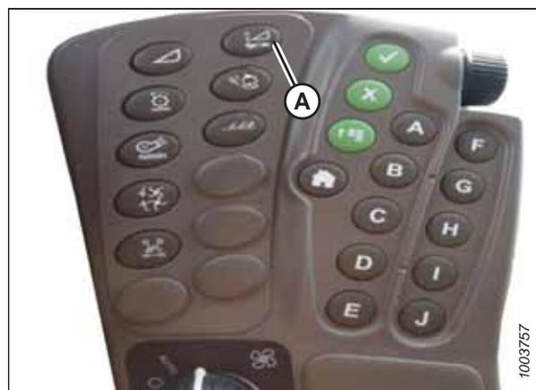
Figure 3.329: Centre de commande des moissonneuses-batteuses John Deere
