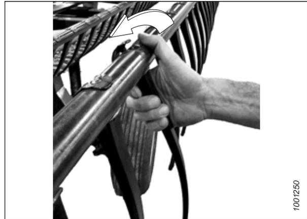
Figure 5.243: Retrait des doigts en plastique
