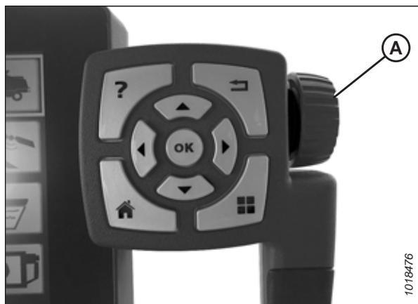
Figure 3.282: Molette de réglage sur la droite du terminal Tyton
