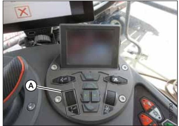
Figure 3.280: Groupe de commande de la plateforme
