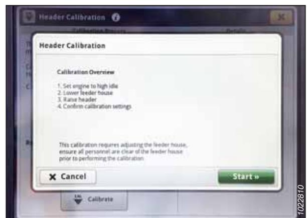
Figure 3.386: Écran John Deere S7 – Étalonnage de la plateforme
