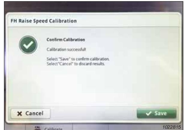
Figure 3.380: Écran John Deere S7 – Étalonnage du convoyeur
