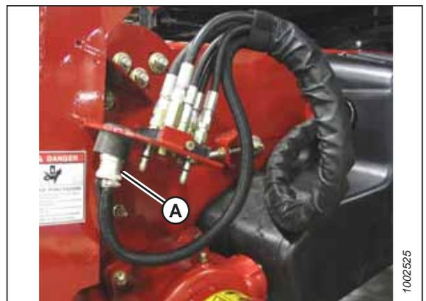
Figure 4.89: Connecteurs de la moissonneuse-batteuse
