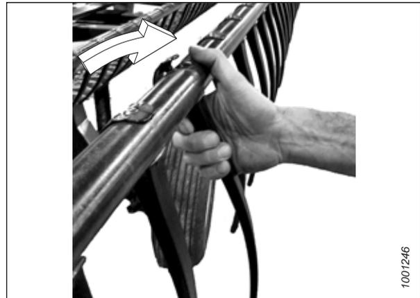
Figure 5.244: Installation des doigts en plastique
