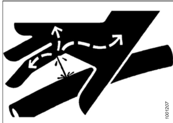
Figure 5.1: Risque lié à la pression hydraulique
