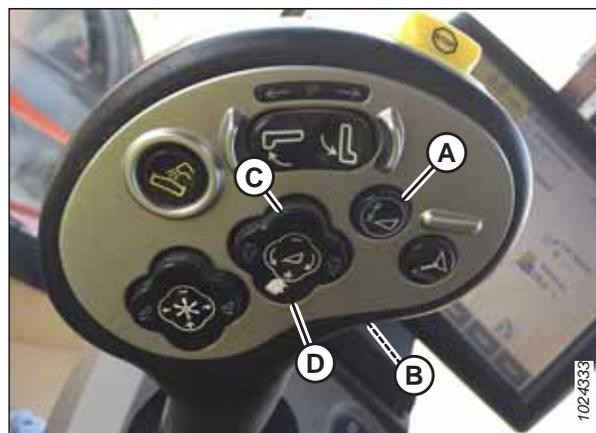
Figure 3.253: Commandes de la moissonneuse-batteuse Case
