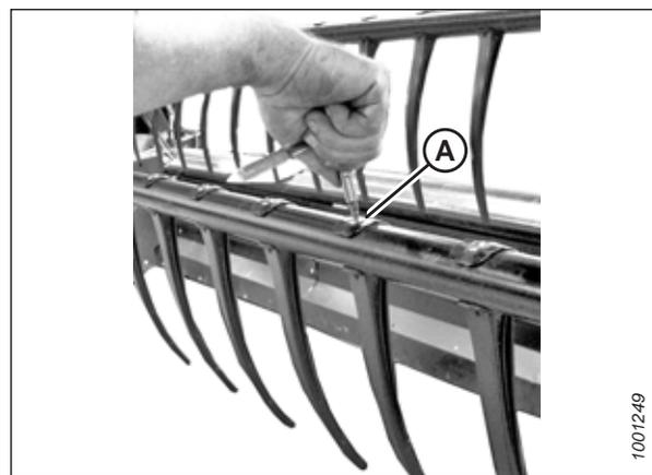
Figure 5.242: Retrait des doigts en plastique
