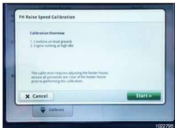
Figure 3.378: Écran John Deere S7 – Étalonnage du convoyeur
