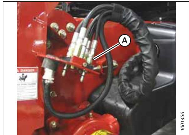
Figure 4.86: Connecteurs de la moissonneuse-batteuse
