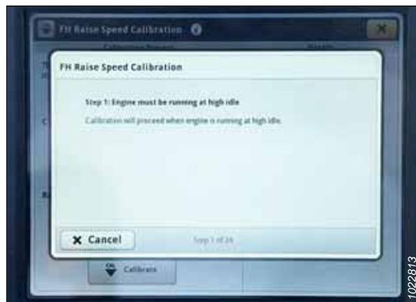
Figure 3.379: Écran John Deere S7 – Étalonnage du convoyeur
