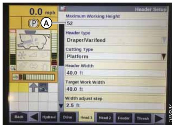
Figure 3.207: Écran de la moissonneuse-batteuse Case – page de configuration de la plateforme
