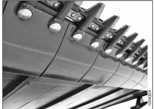
Figure 6.8: Plaques d'usure de la barre de coupe
