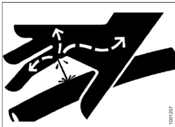
Рисунок 4.239: Опасное давление гидравлической жидкости
