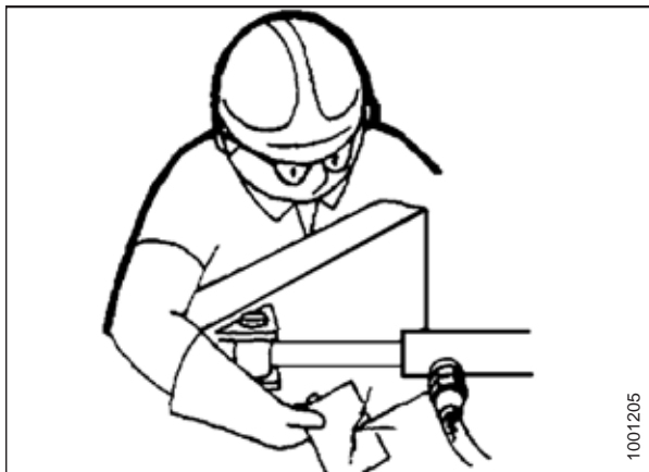
Рисунок 1.11: Проверка наличия гидравлических течей
