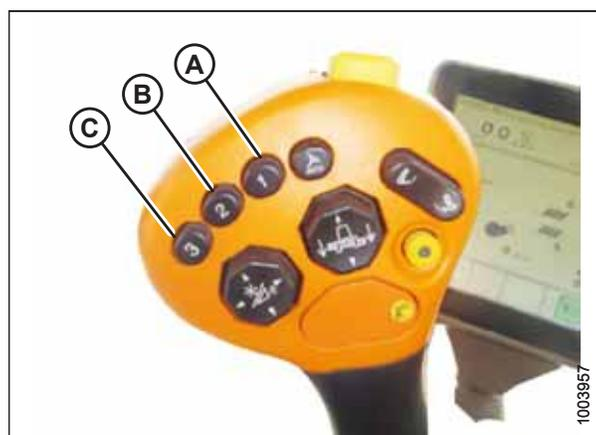
Рисунок 4.99: Кнопки рычага управления
