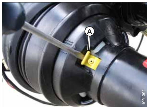
Рисунок 5.16: Защитный кожух кардана привода жатки
