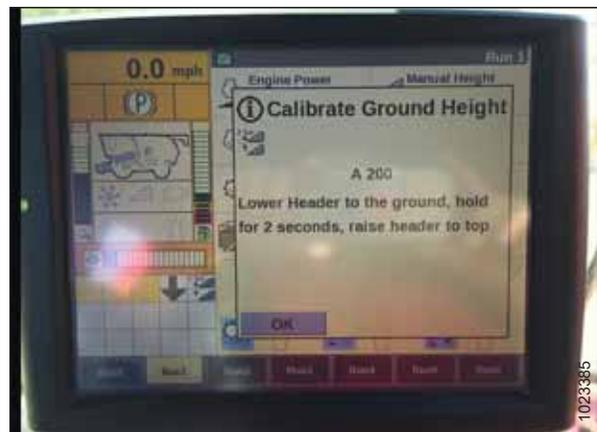
Рисунок 4.34: Калибровка системы автоматического контроля высоты подборщика
