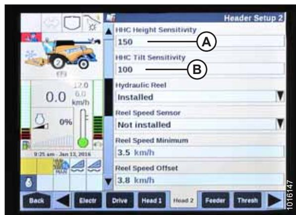
Рисунок 4.121: Дисплей комбайна New Holland
