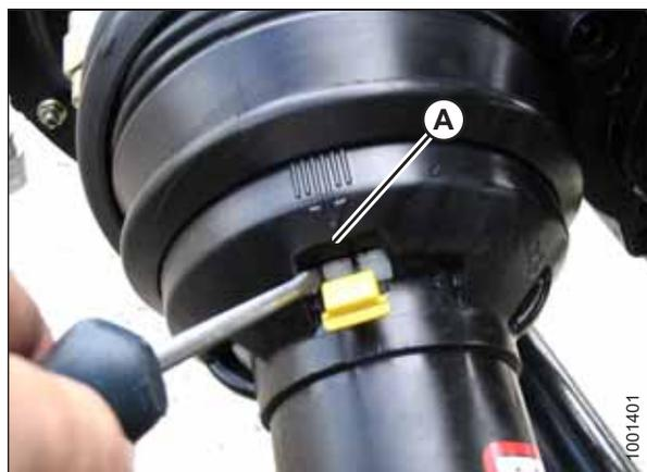
Рисунок 5.20: Кожух кардана привода жатки
