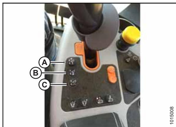
Рисунок 4.131: Органы управления комбайнов New Holland
