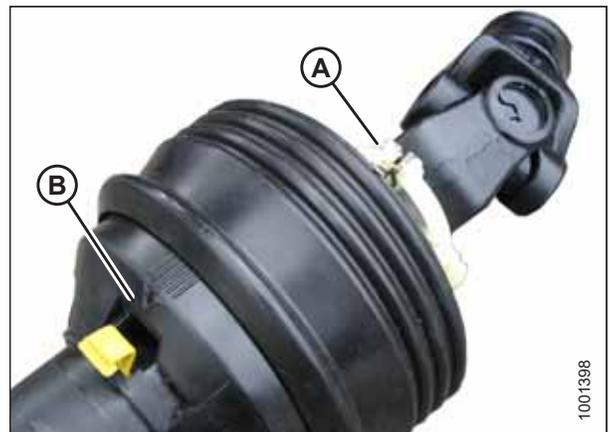
Рисунок 5.18: Защитный кожух кардана привода жатки
