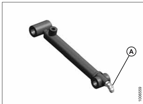
Рисунок 5.185: Вспомогательный гидроцилиндр — Правая сторона жатки
