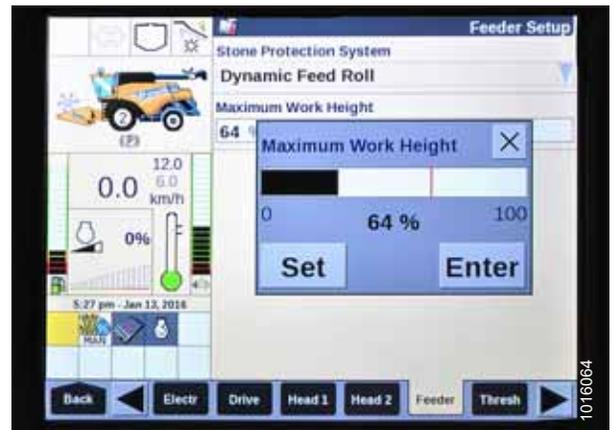
Рисунок 4.136: Дисплей комбайна New Holland
