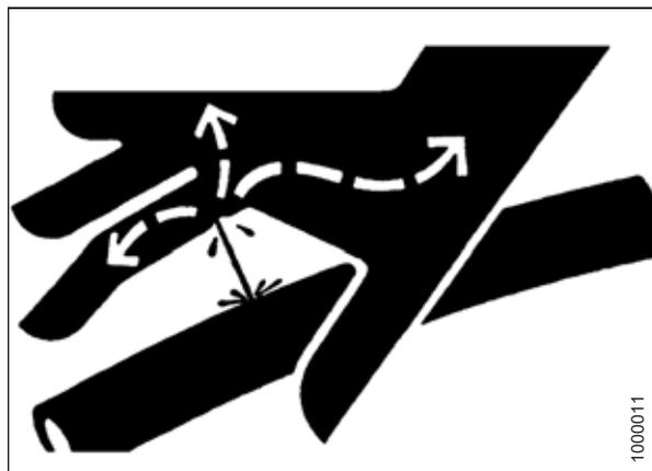
Рисунок 5.190: Опасное давление гидравлической жидкости
