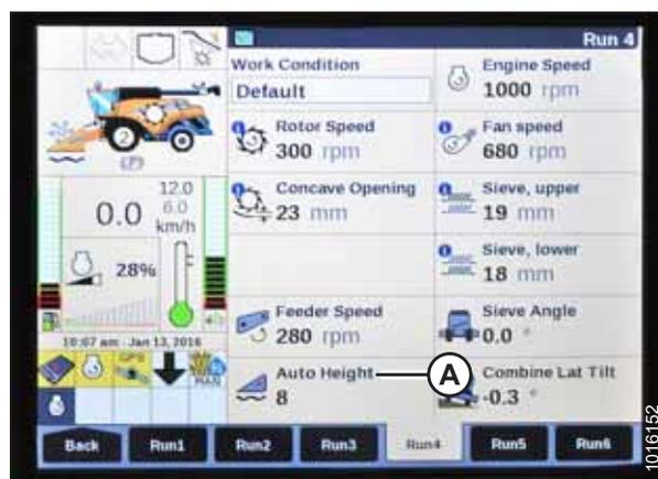
Рисунок 4.133: Дисплей комбайна New Holland
