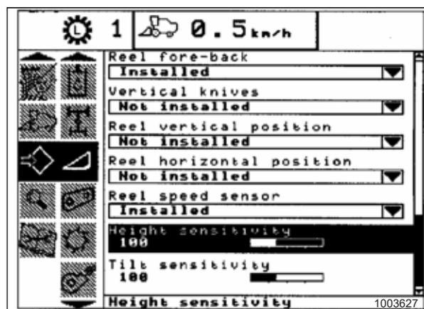
Рисунок 4.113: Дисплей комбайна New Holland
