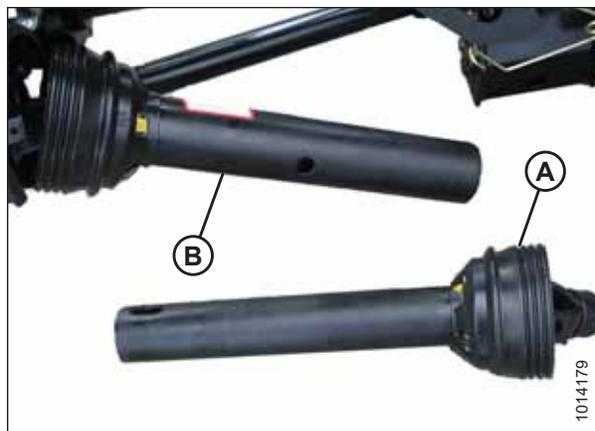
Рисунок 5.15: Раздельный кардан привода жатки
