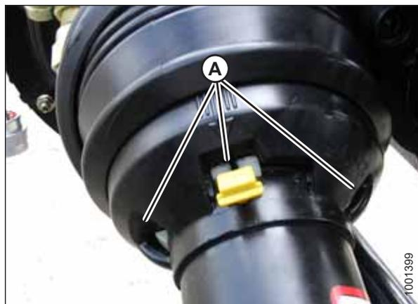
Рисунок 5.19: Защитный кожух кардана привода жатки
