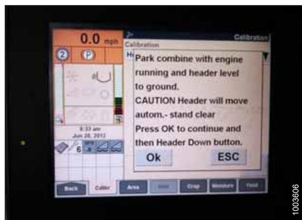
Рисунок 4.59: Приборная панель комбайна Case IH
