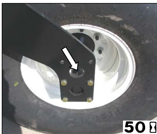
ПОДШИПНИКИ ВИЛКОВОЙ ЦАПФЫ КОЛЕСА (ДВА КОЛЕСА)
