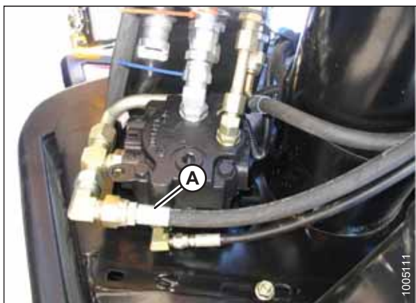
Рисунок 3.42: Шланг возврата — Показана серия D, серия D1 аналогична
