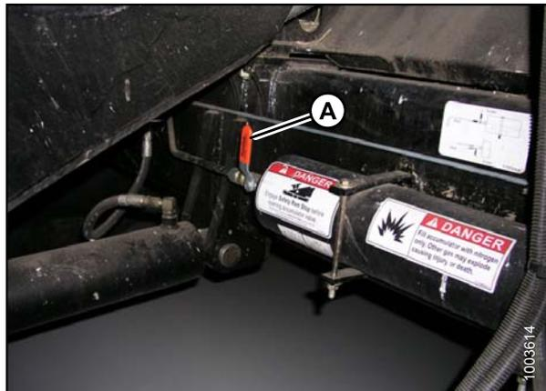
**Figure 8.57: Interrupteur marche/arrêt de l'accumulateur de la moissonneuse-batteuse**
