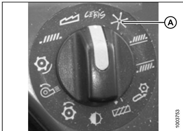
Figure 8.128: Sélecteur rotatif de la moissonneuse-batteuse
