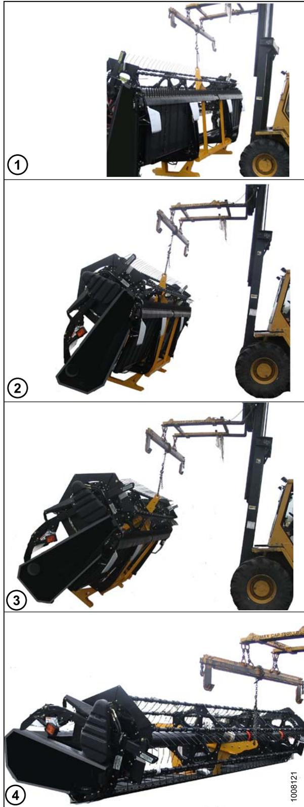
Figure 5.4: Plateforme déchargée sur un sol plat
