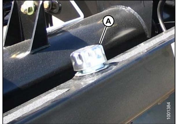
Figure 6.20: Bouchon de remplissage
