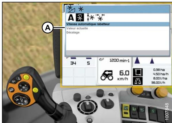
Figure 8.146: Écran de la moissonneuse-batteuse, console et levier de propulsion
