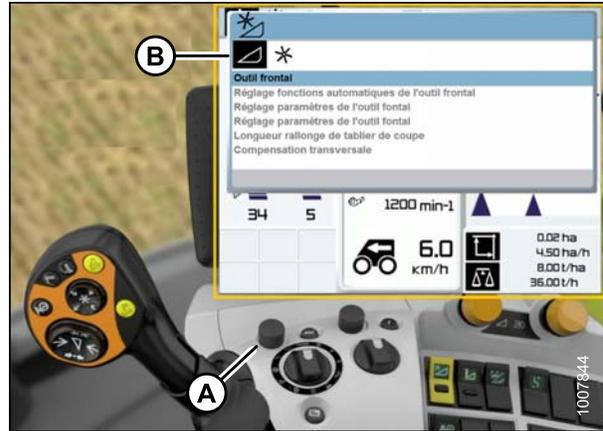
Figure 8.135: Écran de la moissonneuse-batteuse, console et levier de propulsion
