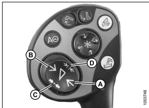
Figure 8.122: Régler manuellement la hauteur de coupe
