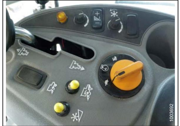
**Figure 8.18: Bouton de réglage de la hauteur sur la console de commande de la moissonneuse-batteuse**
