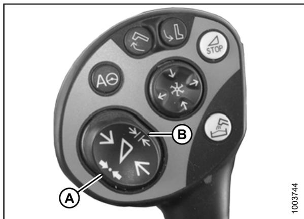
Figure 8.129: Appuyez sur le bouton A ou B pour enregistrer les réglages
