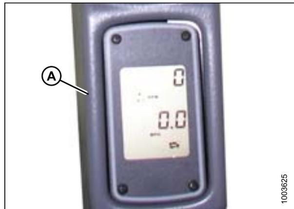
**Figure 8.62: Tachymètre**
