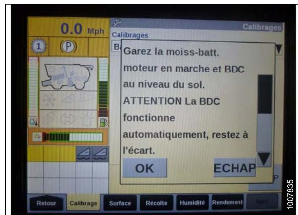
Figure 8.158: Écran de la moissonneuse-batteuse
