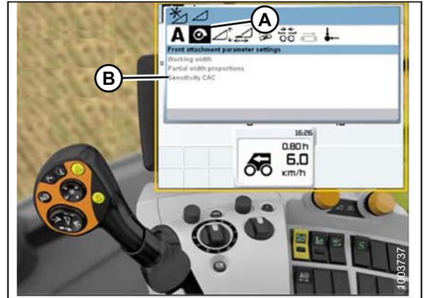
Figure 8.142: Écran de la moissonneuse-batteuse, console et levier de propulsion
