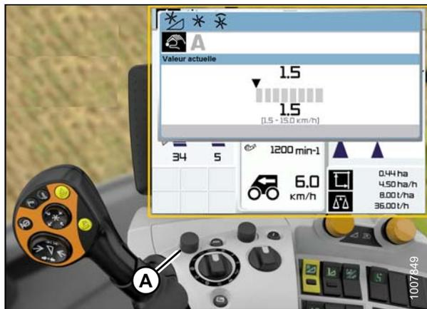
Figure 8.147: Écran de la moissonneuse-batteuse, console et levier de propulsion
