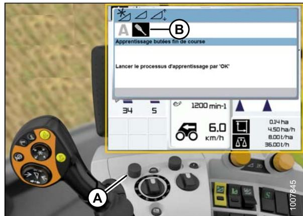
Figure 8.137: Écran de la moissonneuse-batteuse, console et levier de propulsion
