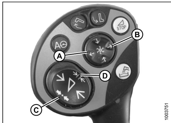
Figure 8.133: Réglez et enregistrez la position avant-arrière du rabatteur
