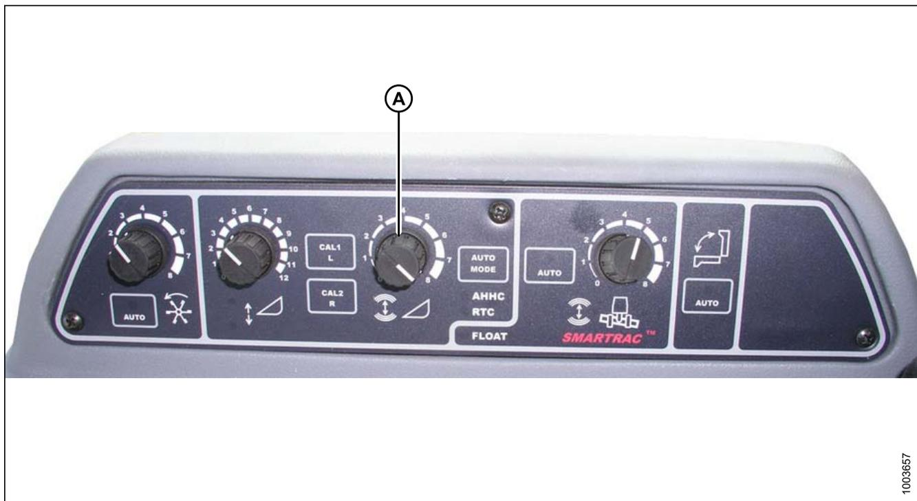
Figure 8.61: Console de contrôle de la hauteur automatique de la plateforme
