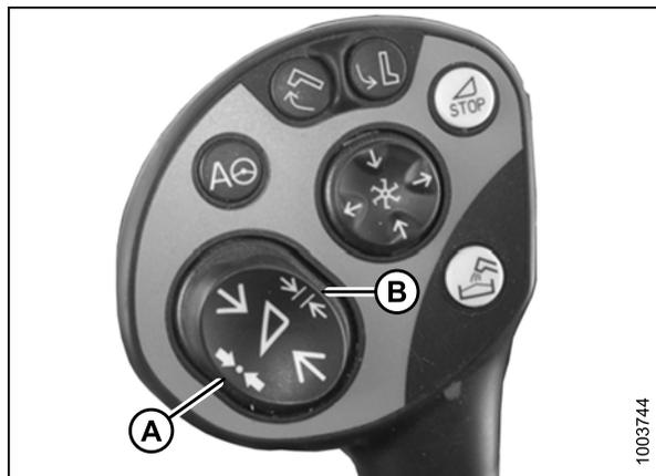
Figure 8.119: Activer le système de contour automatique et les réglages de la hauteur de coupe prédéfinie
