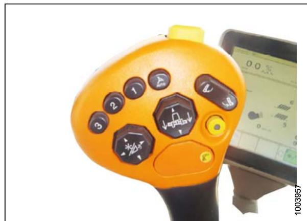
Figure 8.112: Utilisez le levier de commande pour définir les pré-réglages de la pression au sol.
