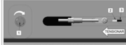
**AJUSTE DE TENSIONAMENTO DA ESTEIRA**
