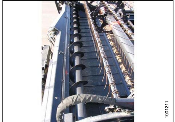
Figure 4.80: Vis transversale supérieure
