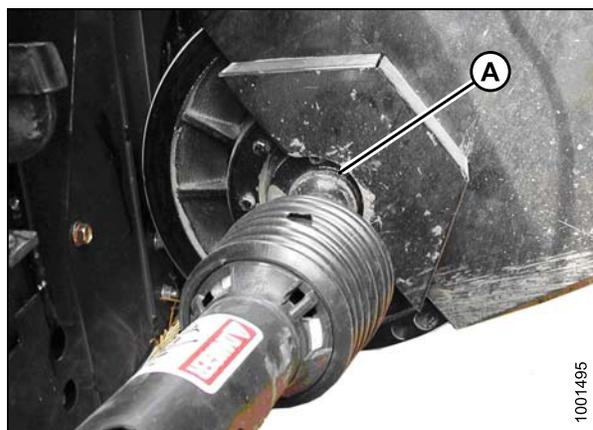
Figure 5.110: Déconnectez l'arbre de transmission
