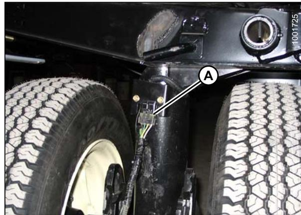
**Figure 4.86: Connecteur de câblage**
