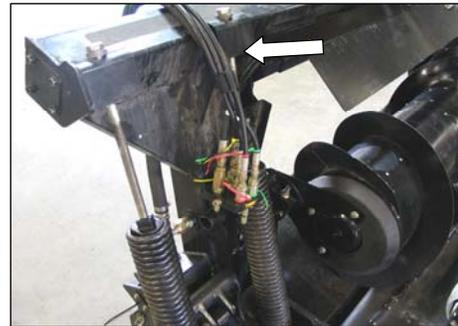
3. Guarde las mangueras sobre el marco del adaptador.
