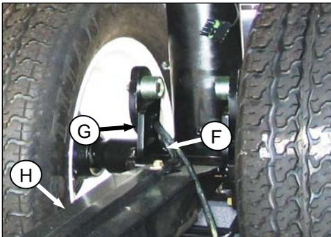
4. Retire el perno sujetador (F) y deje a un lado para su uso posterior
