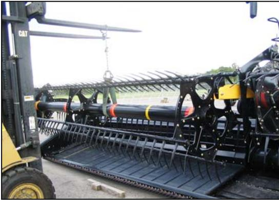
1. Apoye el extremo interno derecho del molinete con un cargador de tractor Y eslingas de nylon (o instalación equivalente).
