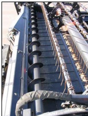
El sinfín transversal facilita la entrega de cultivos tupidos a través del cabezal y sobre la hileradora segadora o dentro de la cosechadora.
