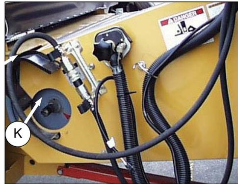
2. Desconecte las mangueras hidráulicas de los conectores del adaptador (L) y (M). Ubique las mangueras (J) y (K) en la cosechadora como se muestra y reconectar.
