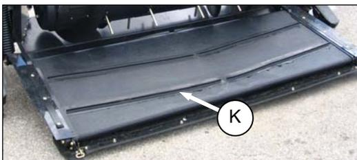
h. Instale la nueva lona sobre el rodillo de transmisión (J) con el listón chevron (k) apuntando hacia el frente del adaptador asegurándose que las guías de la lona encajen en las muescas del rodillo de transmisión (L).
