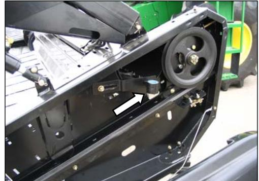
Se puede almacenar una cuchilla de repuesto en el tubo del chasis del cabezal en el lado izquierdo tal como aparece en la foto arriba. Asegúrese que la cuchilla esté trabada en su lugar.
