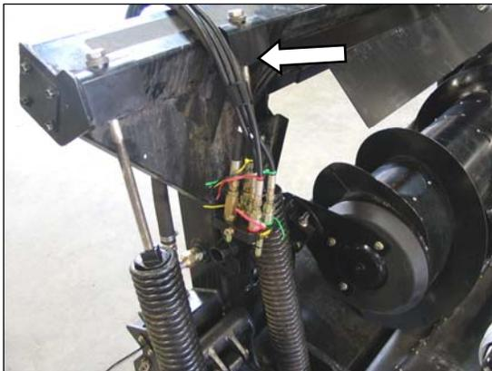
3. Guarde las mangueras sobre el marco del adaptador.
