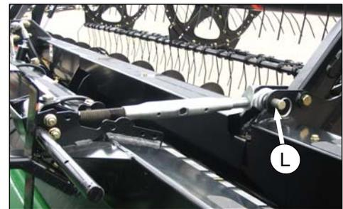
4. Retire el perno (L) para liberar la conexión. Vuelva a colocar el perno.
