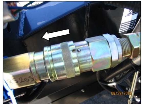
3. Empuje el conector de la manguera sobre el receptáculo de acople hasta que el collar del receptáculo salte en posición de traba.
