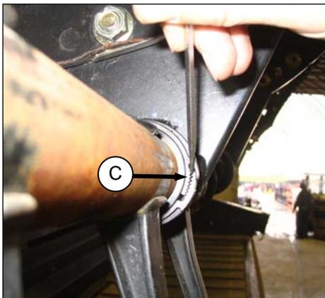
2. Retire las fijaciones del buje (C) utilizando un destornillador pequeño para separar las
