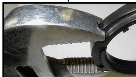
2. Ubique la fijación en los bujes (D) para que los bordes de la fijación y los bujes estén pegados cuando la fijación enganche en la ranura del buje y se accione la traba.
