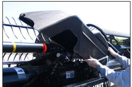
c. Para colocar la cubierta, ubique el extremo interno sobre la conexión y detrás de la barra de medición (C).
