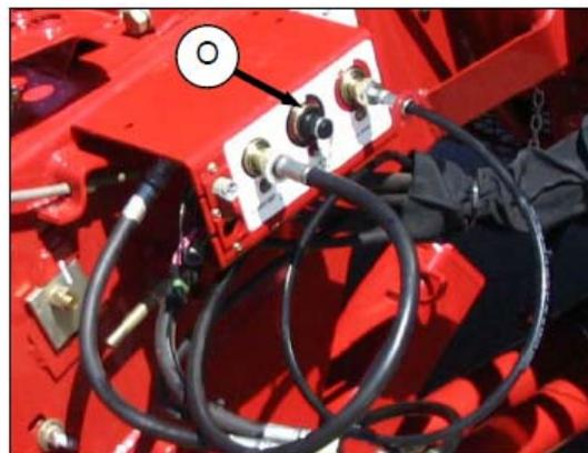
4. Retire el acople del levante del molinete (O) (disco negro) de la cosechadora.
