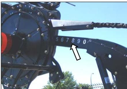
Se proporciona una calcomanía de medidor en el brazo de soporte derecho del molinete para identificar la mejor posición. El borde trasero del disco del excéntrico del molinete es el indicador de medidor.
