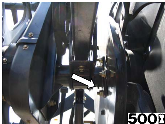
Центральный Подшипник Мотовила (1 МЕСТО) Только у Двойных Мотовил
