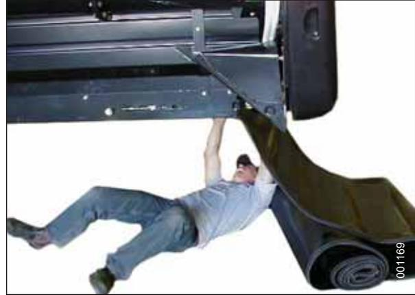
Рисунок 5.102: Установка полотна
