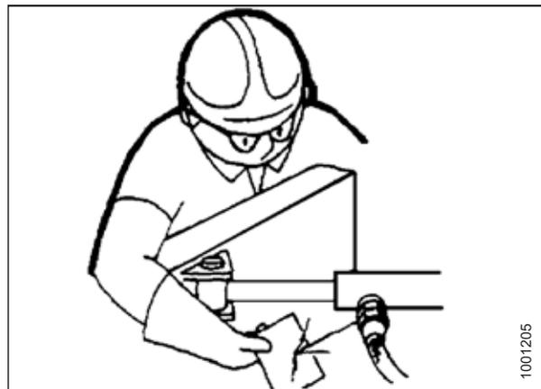
Рисунок 5.4: Проверка наличия гидравлических течей
