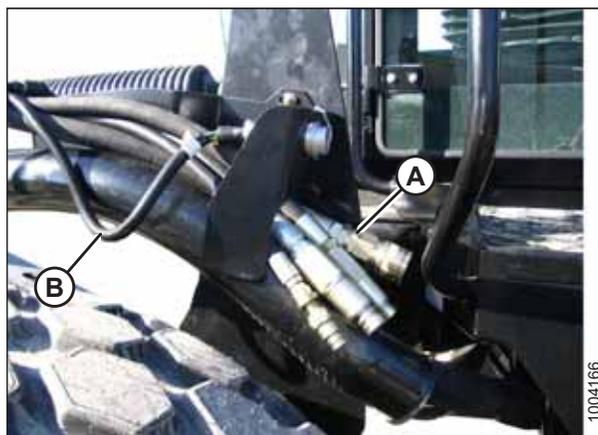
Рисунок 4.1: Шланги привода жатки
