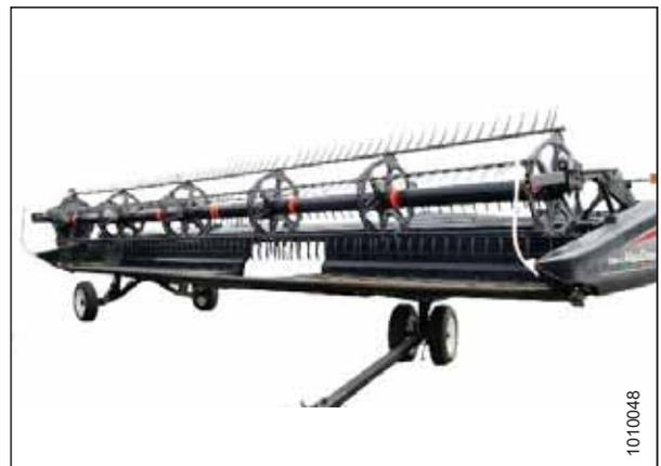
Рисунок 6.14: Стабилизирующие и опорно-транспортные колеса
