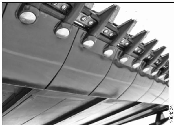
Рисунок 6.6: Противоизносные пластины ножевого бруса
