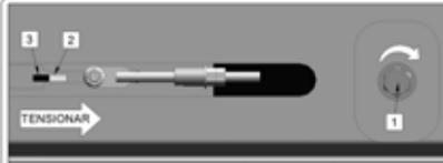
**AJUSTE DE TENSIONAMENTO DA ESTEIRA**
