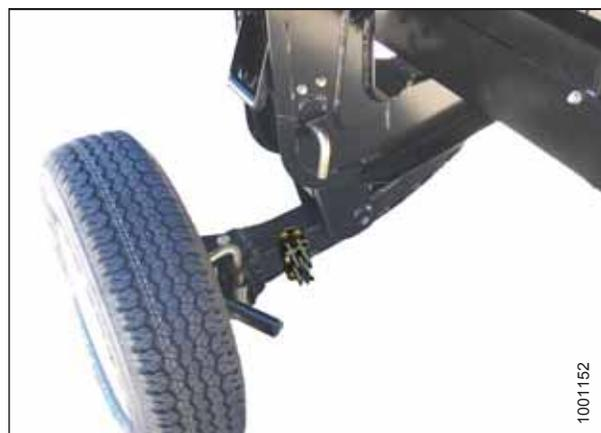
9. Tirez la goupille (A) et faites pivoter la roue arrière droite (B) dans le sens des aiguilles d'une montre à 90 degrés.
