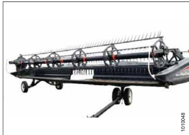
Figure 6.15: Roues stabilisatrices et transport
