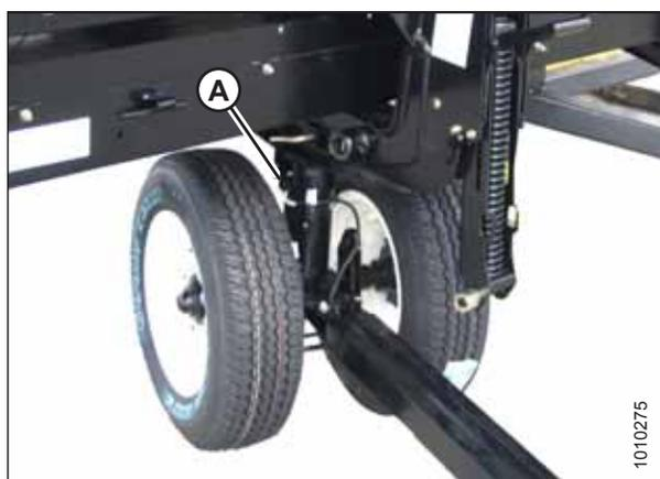
Figure 3.89: Raccordement du faisceau
