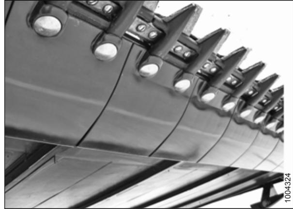
Figure 6.7: Plaques d'usure de la barre de coupe
