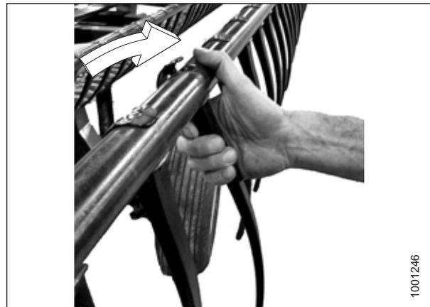
Figure 5.178: Installation des doigts en plastique
