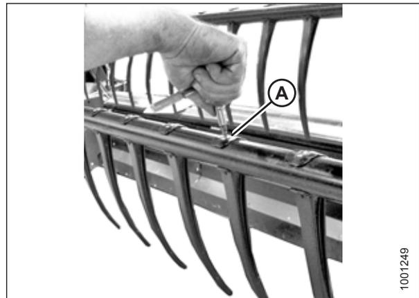
Figure 5.179: Installation des doigts en plastique
