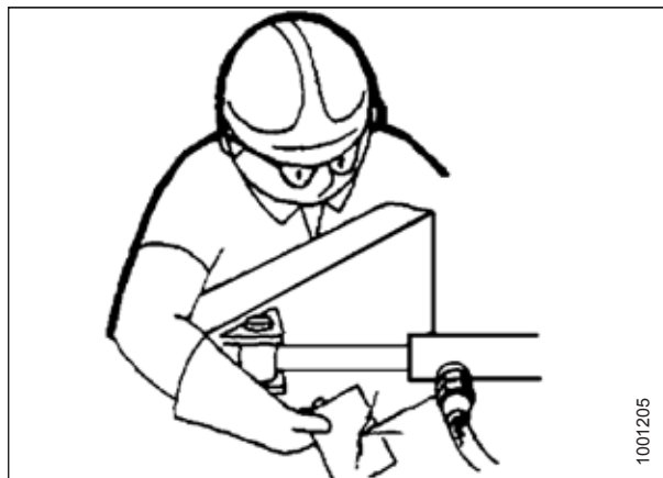
pav. 5.4: Hidraulinių nuotėkių tikrinimas
