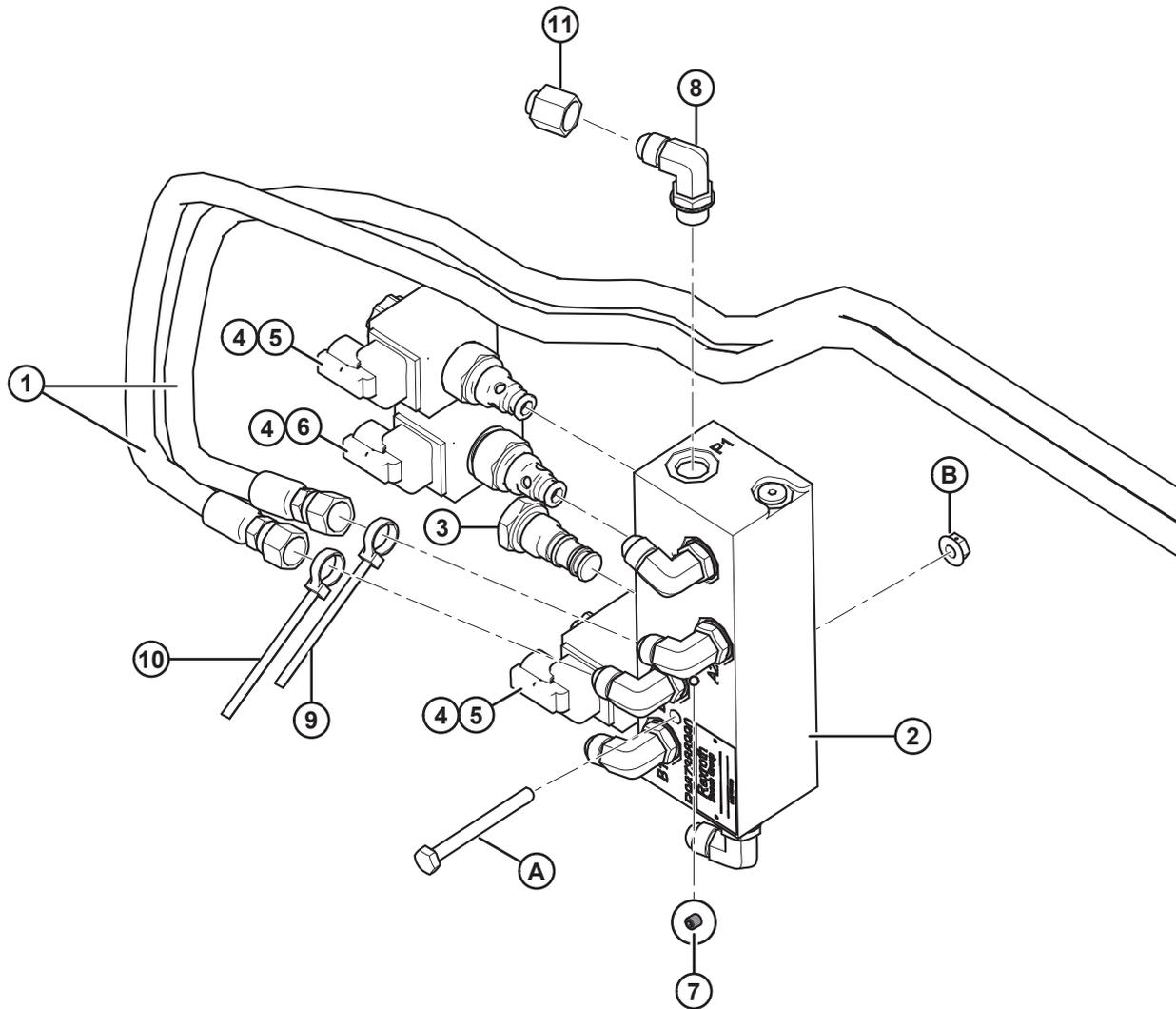
**SELETOR HIDRÁULICO DE INCLINAÇÃO DA PLATAFORMA / AVANÇO-RECUO DO MOLINETE**
