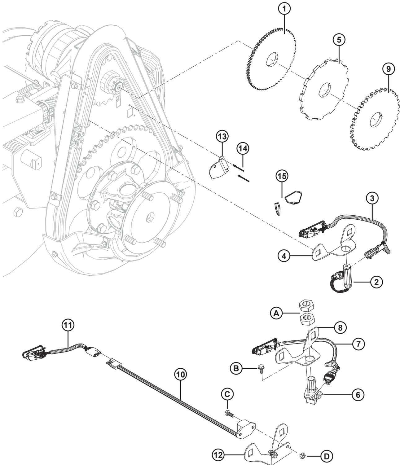
**SENSORES DE VELOCIDADE DO MOLINETE**
