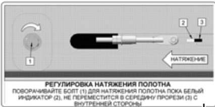
**РЕГУЛИРОВКА НАТЯЖЕНИЯ ПОЛОТНА**
