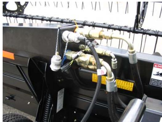
Позволяют быстро отсоединять гидравлические шланги между адаптером и жаткой и легкого отсоединения адаптера от жатки.
