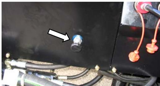
Скорость полотен жатки регулируется вентилем потока на адаптере комбайна. Поворачивайте вентиль с закрытого положения для регулирования скорости полотен для достижения хорошей подачи культуры на полотно адаптера. Излишняя скорость полотна уменьшает срок его службы.
