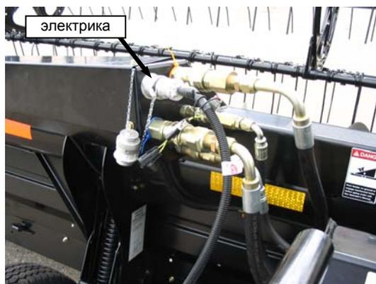
1. Снимите крышку на коннекторе.
