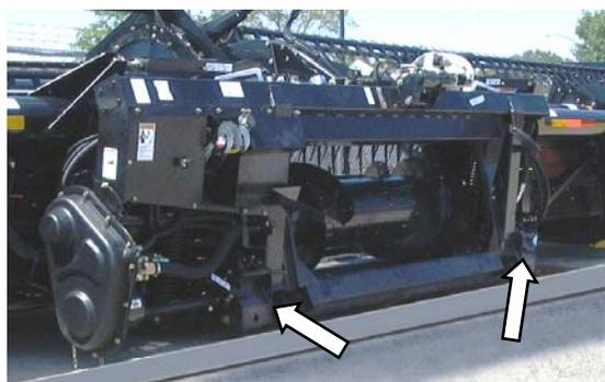
Замки флотации должны быть заперты когда жатка транспортируется с присоединенным адаптером, так чтобы не было относительного перемещения между ними. Замки флотации должны быть закрыты во время отсоединения от комбайна позволяя наклонной камере освободить адаптер. Два замка на адаптере- по одному с каждой стороны.
