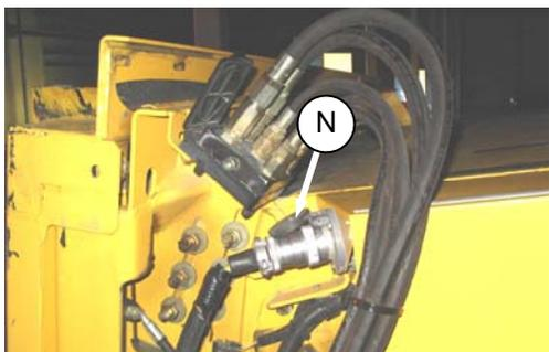
1. Соедините электрический разъем (N) следующим образом:
