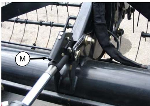
1. Для гидравлической регулировки, поднимите защелку (М) и закройте ее в верхнем положении.
