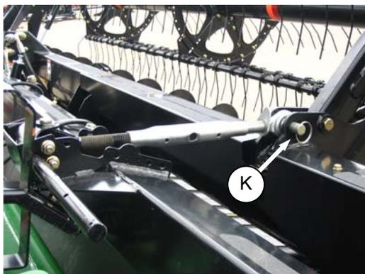
4. Для механического звена, снимите палец (K) и отодвиньте звено. Вставьте палец на место
