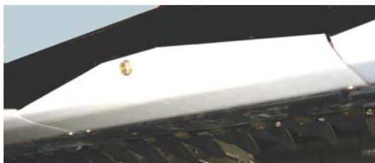
Используются как приспособление для переходного поддона режущего аппарата на D50 и D60 Уборочных жатках (опция), и стандартное на FD70 Гибкой. Рекомендуются для работы где земля липнет к металлу.
