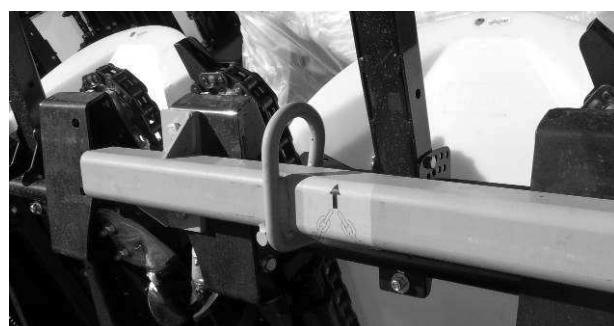
Вершины делителей разместите (защелкните) на цапфах верхнего покрытия (1)! В целях более легкого монтажа сначала ослабьте шестигранные болты, которые крепят цапфы верхнего покрытия (2), закрепите вершину делителя сверху болтами внутреннего открывания (3), а затем затяните расслабленные ранее шестигранные болты! Рисунок, облегчающий монтаж, находится на странице 21/A перечня запчастей.
