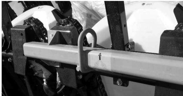
Die Spitzen an die Bolzen der oberen Verkleidung anlegen (1). Wegen der leichteren Montage zuerst den Bolzen der oberen Verkleidung befestigende Sechskantschrauben (2) lockern, die Spitzen von außen mit den Inbusschrauben (3) befestigen, und die früher gelösten Schrauben anziehen (2). Die Montage erleichternde Explosionszeichnung und Ersatzteilliste ist auf der Seite 21/A.
