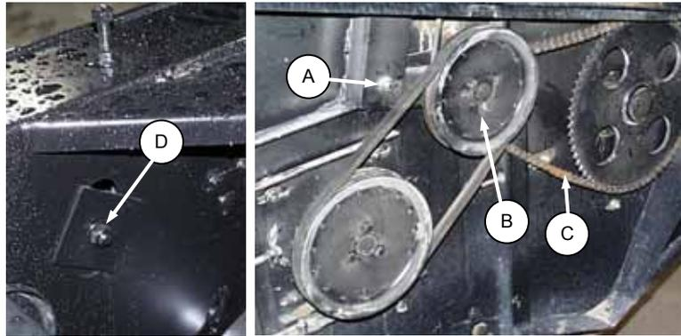
REEL DRIVE CHAIN TENSION ADJUST
