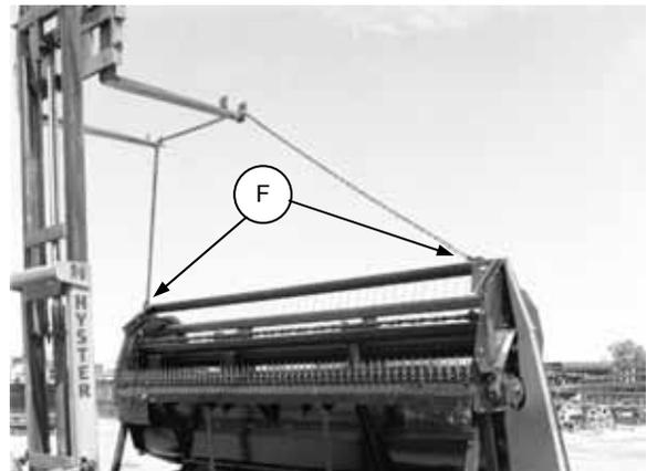
ATTACH CHAIN & LOWER ONTO BLOCKS
