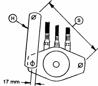
ORIENTATION OF TORQUE ARM TO MOTOR
