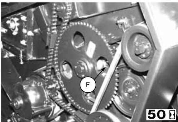
AUGER SHAFT BEARING - LEFT SIDE
