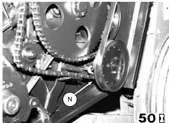
AUGER DRIVE JACKSHAFT BEARINGS
