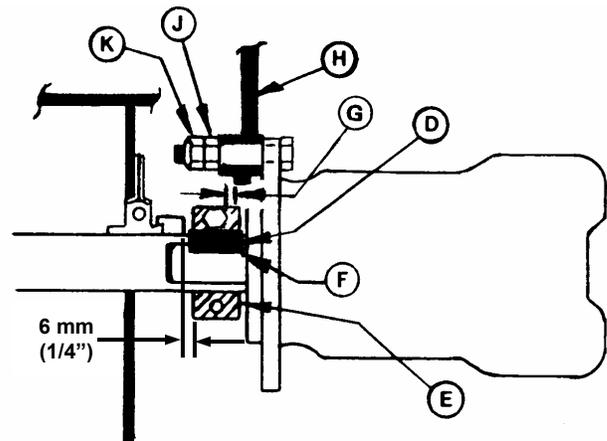
INSTALL MOTOR & ATTACH TORQUE ARM
