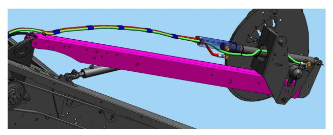
2) ASSEMBLE HOSE SLEEVES. TIGHTEN SLEEVES VIA VELCRO AS TIGHT AS POSSIBLE AROUND HOSES.
