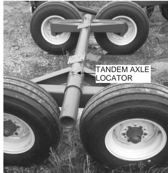
TANDEM AXLES ON AXLE BEAM
