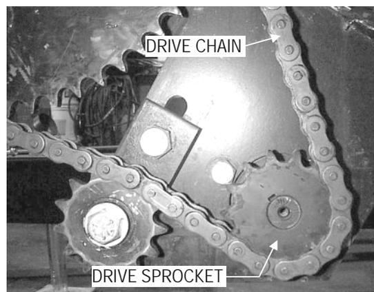
INSTALL DRIVE SPROCKET
